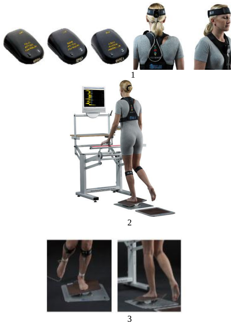
Рис. 7. Система для контроля статической и динамической позы тела человека фирмы «Delos»: 1 – датчик контроля позы; 2 – дополнительное средство по удержанию позы; 3 – платформа равновесия [8]
